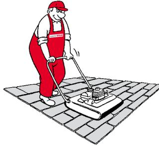
Nur trockene Flächen dürfen abgerüttelt werden. Der Pflasterbelag sollte vorher sorgfältig gesäubert werden. Vor dem Abrütteln muss die Pflasterfläche ausreichend mit Fugenmaterial verfügt werden. Überschüssiges Fugenmaterial ist vollständig abzukehren, damit ein Zermahlen des Fugenmaterials und damit eine Verschmutzung der Oberfläche vermieden wird.
