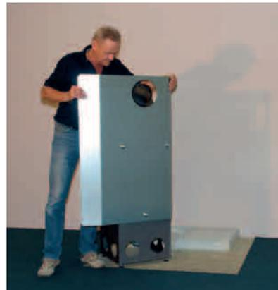
Wärmeschutzblech (Zubehör) montieren
