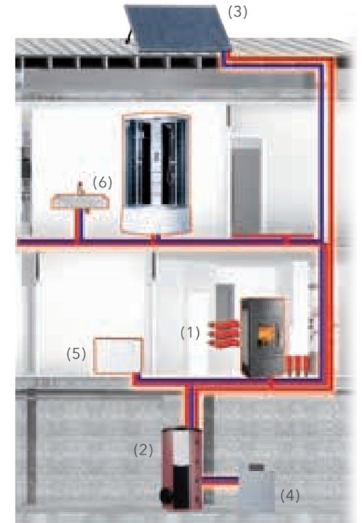
Ein Teil der Wärme wird für die direkte Raumbeheizung (1) verwendet. Der Rest wird von einem Pufferspeicher (2) aufgenommen, der auch von anderen Energiequellen wie Solaranlage (3) oder Heizkessel (4) beschickt wird. Je nach Bedarf wird die Wärme aus dem Puffer für die Einspeisung in die Zentralheizung (5) oder für die Trinkwassererwärmung (6) verwendet.
