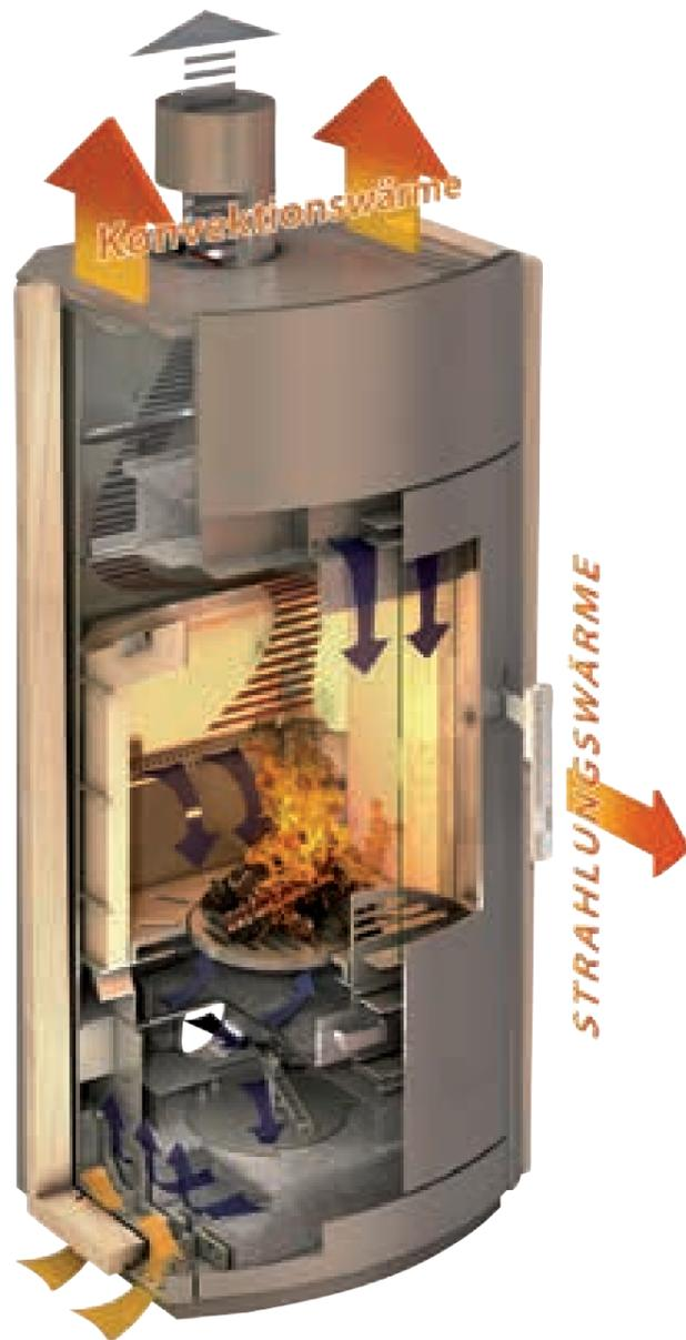
**AUTO AIR 12V** Vollautomatische, elektronische Luftregelung "i-control"
